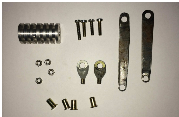
Figura 16 – Bielas de Chapa de Ferro Reaproveitado, Parafusos, Rebites, Porcas e Trocador de calor de Alumínio.
