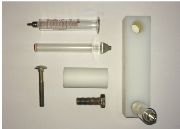
Figura 13 – Bloco de Nylon Technyl, Tarugo de Poliuretano e Seringas 10ml e Parafusos.
